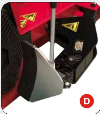
**SISTEMA DI STALLONATURA:** braccio dotato di cilindro a doppio effetto ad alta efficienza ed equipaggiato con un meccanismo brevettato che permette di ottenere due diverse inclinazioni di lavoro tra paletta e ruota, migliorando così l'accuratezza dell'operazione di stallonatura. Anche l'appoggio ruota è regolabile in 2 posizioni di lavoro.
