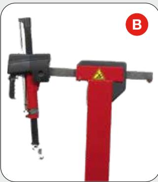
**BRACCIO OPERANTE:** a scelta con movimentazione manuale tramite molla rinforzata o con movimentazione pneumatica (**versione P**) a mezzo di un cilindro per ottenere un migliore livello di sicurezza e precisione. Il palo verticale è dotato di boccole coniche e sistemi di recupero giochi per facilitare le operazioni di manutenzione.
