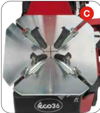
**PIATTO AUTOCENTRANTE:** sistema che permette di serrare cerchi da 10" a 25" senza regolazioni né adattatori: capacità di serraggio interno 10"-22", esterno 13"-25". La speciale geometria del gruppo di serraggio griffe dotato di bielle curve permette di mantenere costante la forza di bloccaggio al variare del diametro del cerchio.
